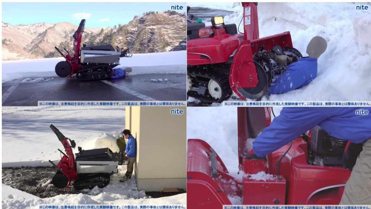
図 16 除雪機の死亡事故の再現イメージ
