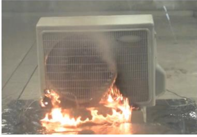
外火によりエアコン室外機が燃える様子（イメージ）
