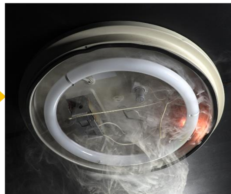
LEDランプが発煙・発火（再現実験）
