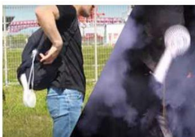
携帯用扇風機の破裂
