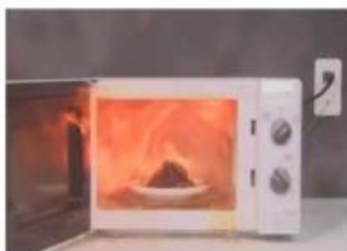
電子レンジで 肉まんが破裂・発火
