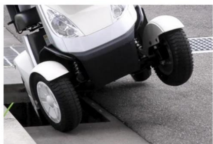
電動車いすが側溝で脱輪
