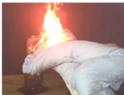
電気ストーブにふとんが接触して発火
