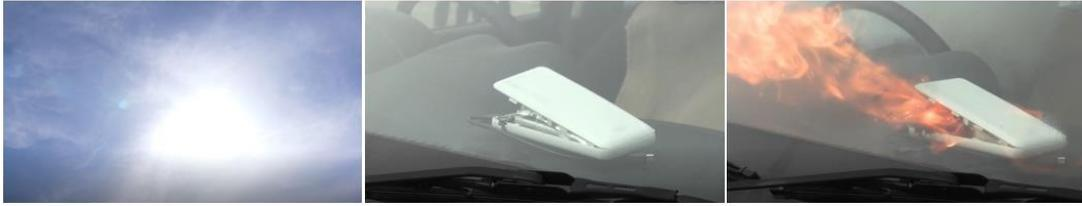
真夏の炎天下に駐車した車のダッシュボードにモバイルバッテリーを放置して発火（再現試験）
