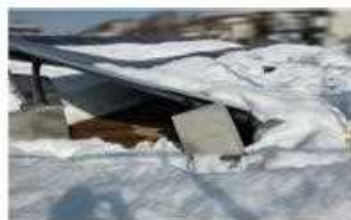
〔図1〕 積雪による太陽電池発電設備の破損 出典：「地上設置型太陽光発電システムの設計ガイドライン 2019 年版」 （国立研究開発法人新エネルギー・産業技術総合開発機構）
