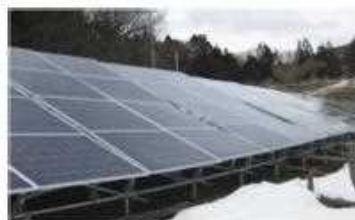
〔図1〕 積雪による太陽電池発電設備の破損 出典：「地上設置型太陽光発電システムの設計ガイドライン 2019 年版」 （国立研究開発法人新エネルギー・産業技術総合開発機構）
