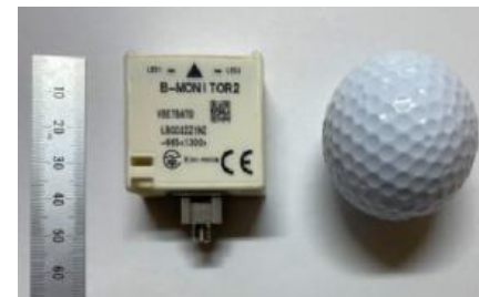
小型無線式センサの外観（左）とポンプにセンサを設置した状態（右）
