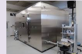
VOC等放散測定大形 チャンバーシステム
