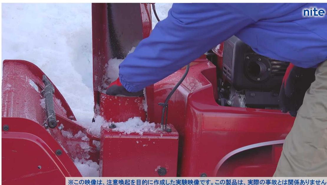
図 15 除雪機に手を突っ込む重傷事故のイメージ
