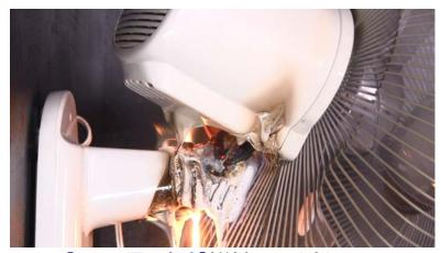
【NITEの再現実験】断線部から発火して、 周囲の可燃物に着火する様子。
