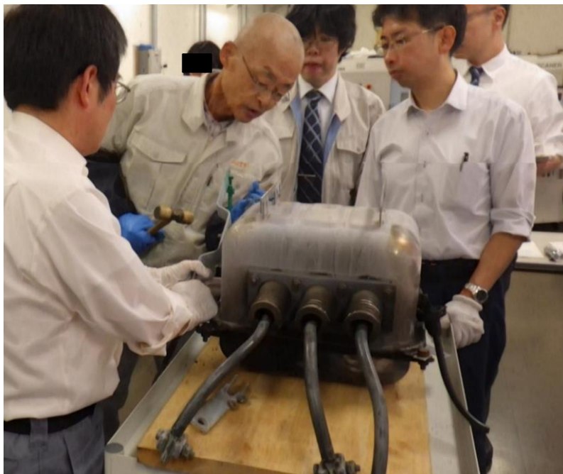
例1 焼損したPASの解体調査
