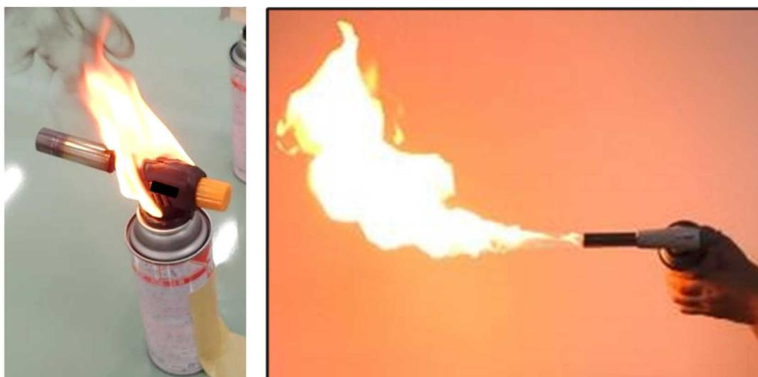
図 15 ガストーチ接続部からのガス漏れによる着火、ガストーチ異常燃焼
