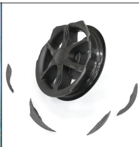
【実験写真】使用者の空気の入れすぎによりタイヤが破裂し、車輪の破片が飛散
