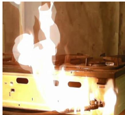
写真2. ゴム管の劣化亀裂による火災
