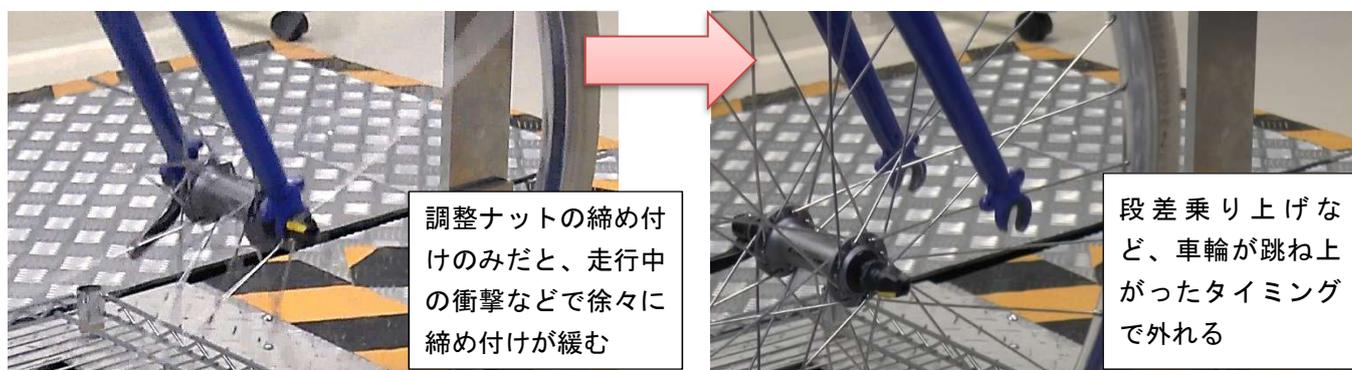
クイックリリース方式の車輪で調整ナットの締め付けのみで固定し走行中に車輪が外れる状況
