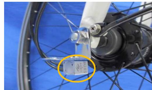
写真7 2軸加速度センサ
