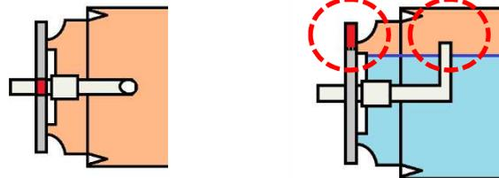
切り欠きの位置と内部ノズルの先が一致するようになっており、使用時には気体が出るように作られている。
