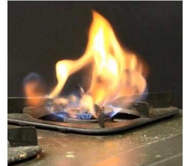
(写真) ガスこんろのバーナーキャップが汚れて点火不良となり異常燃焼した様子
