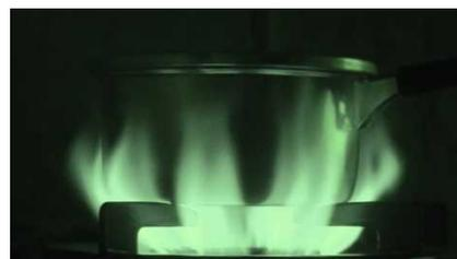
(写真) ガスこんろで加熱中の鍋を赤外線カメラで見た様子
