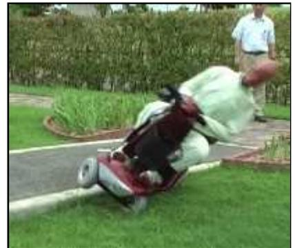
(再現実験) 走行中の路肩から脱輪して転倒する様子
