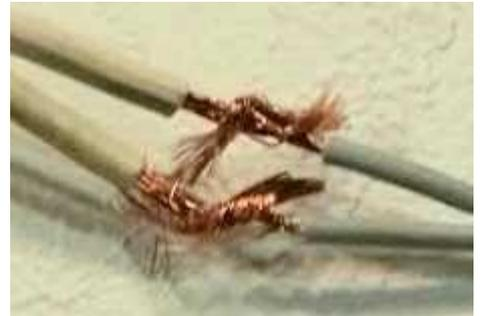
(写真)電源コードのねじり接続
