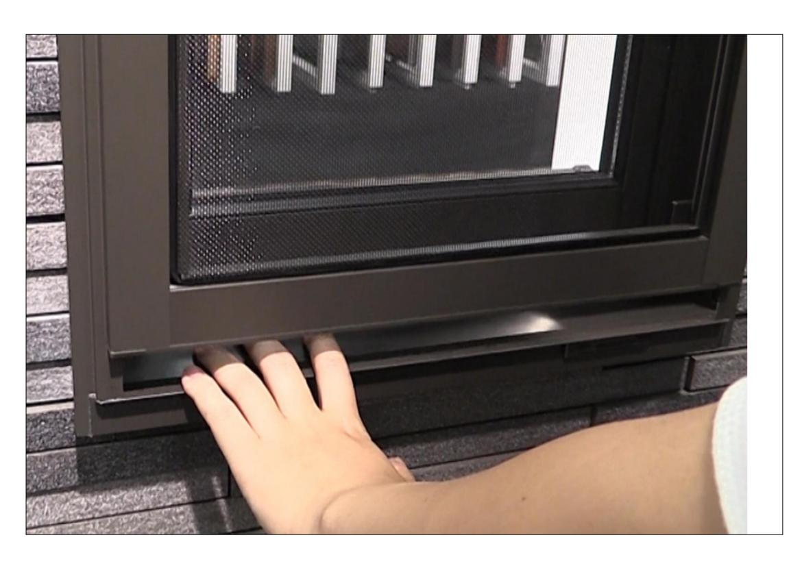
【NITE再現実験の様子】 網戸にストッパーをかけていな かったため、落下した網戸に指を 挟む様子。
