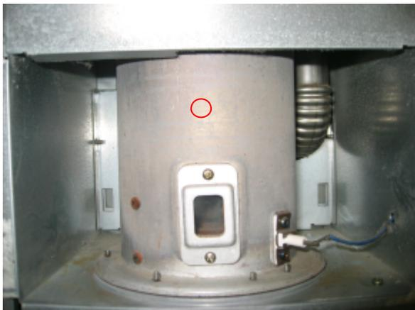
写真5 燃焼筒の採取位置
