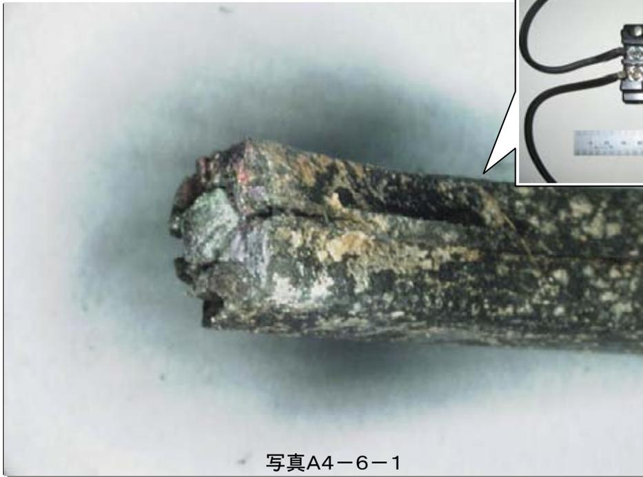
写真A4-6-1は、一次被熱(接続不良)条件による発火直後の断線部で吹き出し写真の赤円で示した部分。
