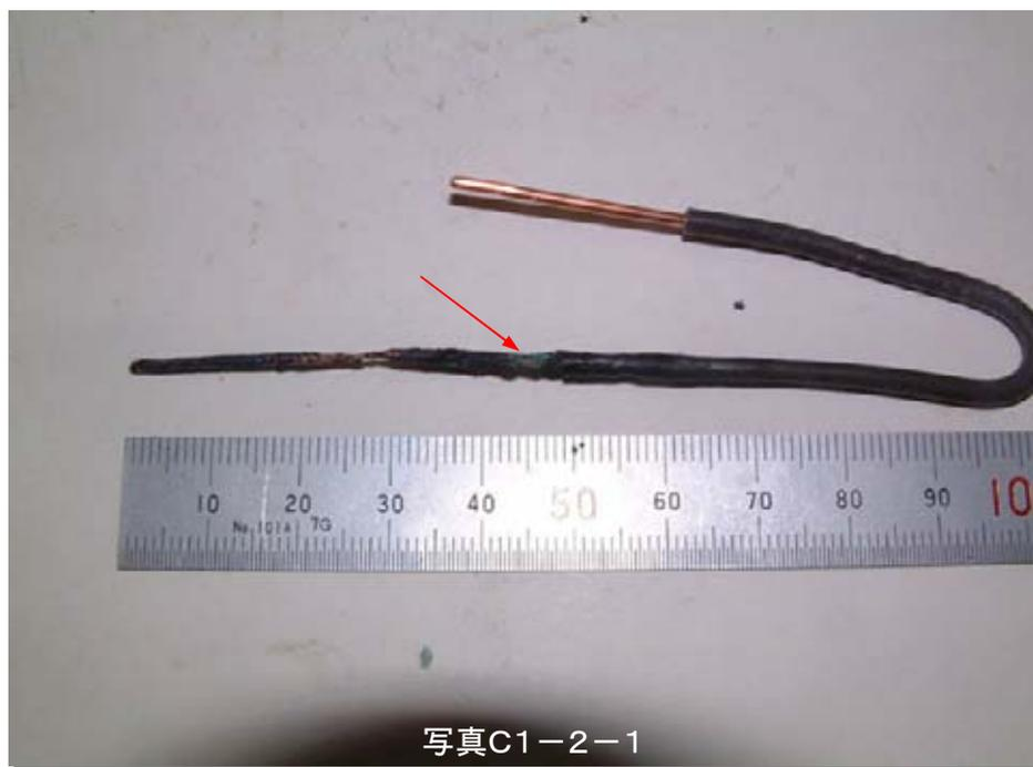
写真C1-2-1は、一次被熱(接続不良)条件による発火後のサンプル。
