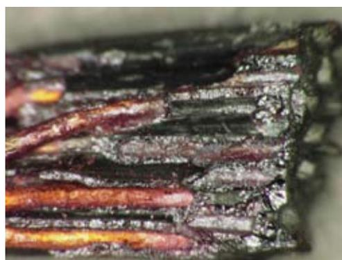
写真 27 断線部内部に残存したルビー色の生成物(試料No.4)
