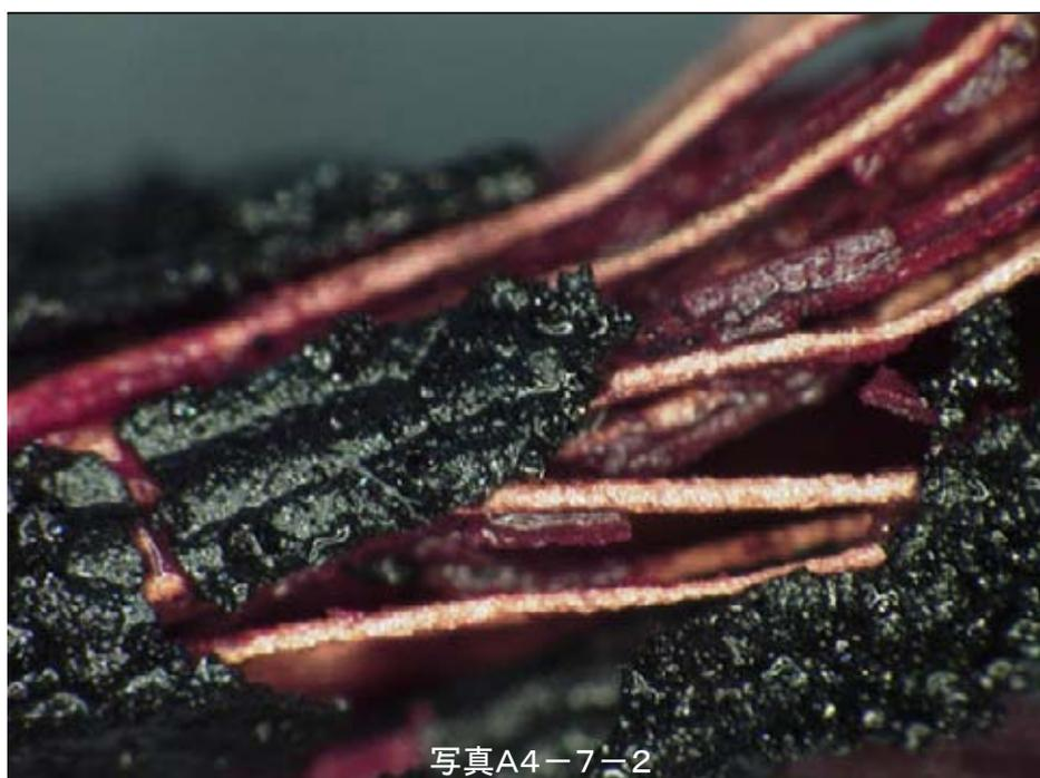
写真A4-7-1及び写真A4-7-2の加熱後のサンプル素線間には、一見、一次被熱サンプルと類似の銅化合物が見られたが、一次被熱サンプル特有の素線間の隙間を埋め尽くすほどの堆積状態とは明らかに異なる。
