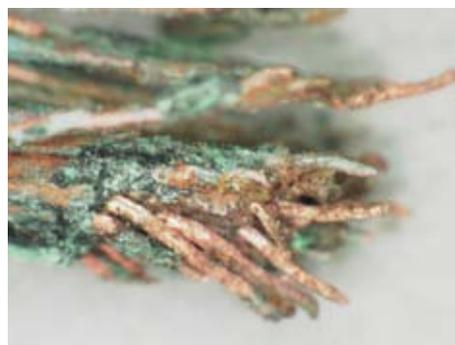
写真7 一次被熱サンプルでテーパ-状に線径が減少した素線(試料No.2)
