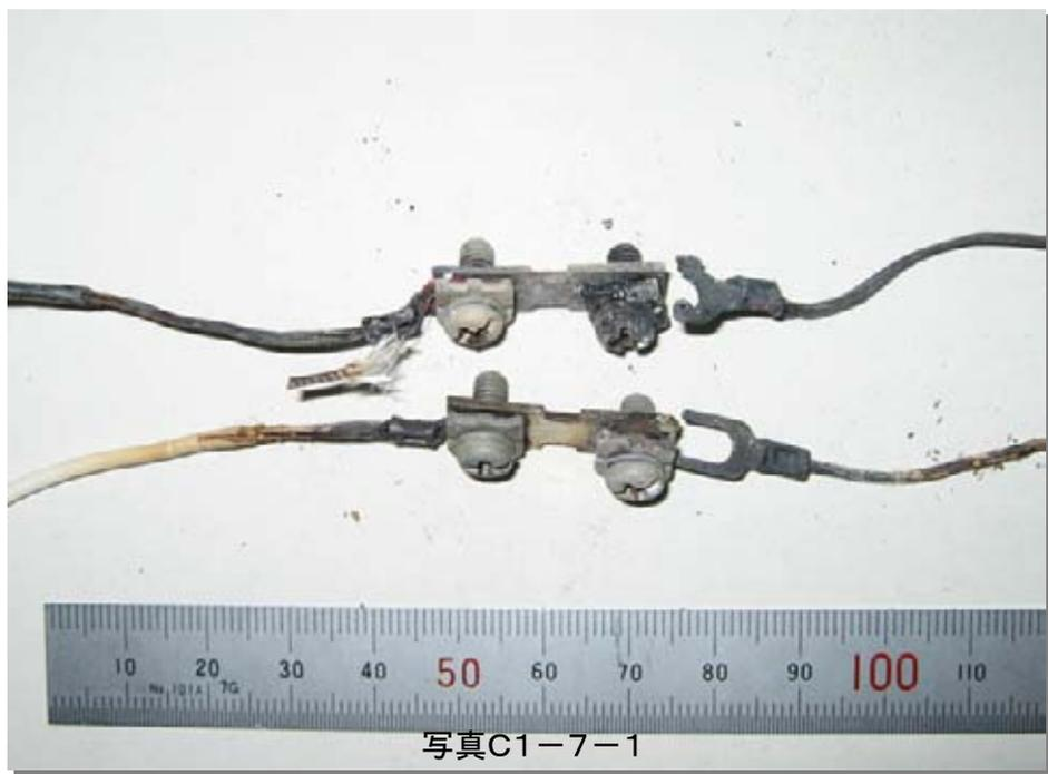
写真C1-7-1は、一次被熱(接続不良)条件による発火後のサンプル。緑青は見られない。
