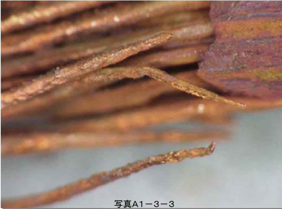
写真A1-3-3は写真A1-3-2で、観察されたテーパ状に痩せた素線の拡大。
