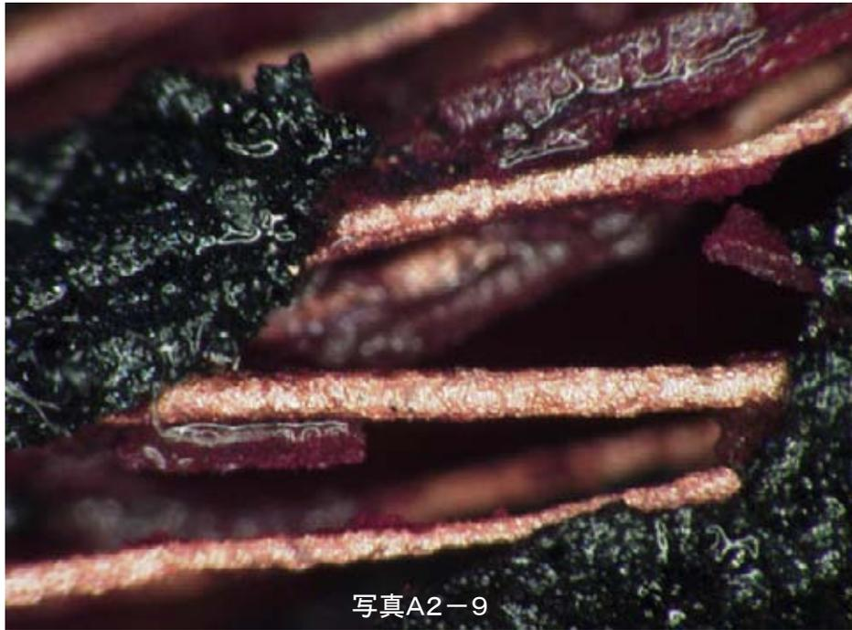
写真A2-9は、二次被熱(電気炉加熱)によってVFFサンプルに生じた表面荒れで、二次被熱サンプルでは特殊条件下(本文1頁参照)でないとほとんど観察されないと思われるもの。
