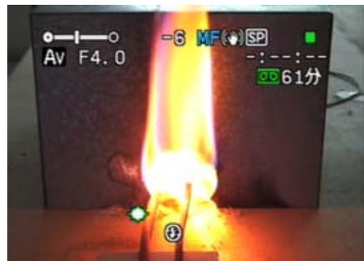
写真4 断線時に発火するNo.3 試料
