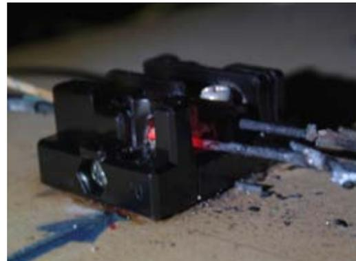
写真2 端子部接続不良で赤熱するNo.1 試料
