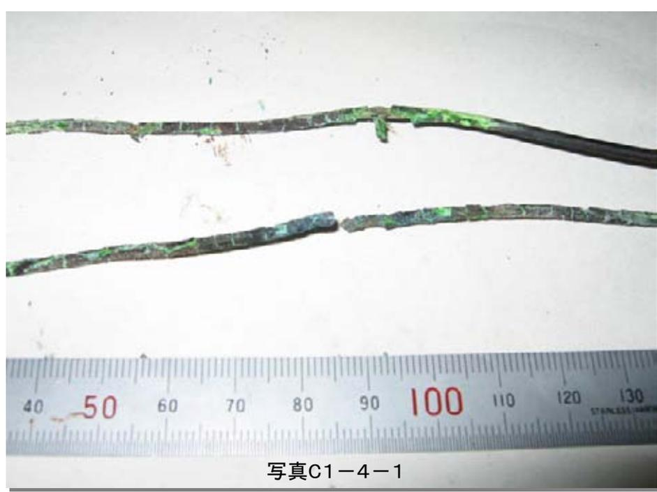
写真C1-4-1は、一次被熱(過電流)条件による発火後のサンプル。
