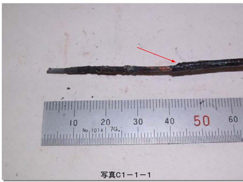
写真C1-1-1は、一次被熱(接続不良)条件による発火後のサンプル。
