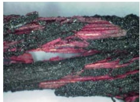
写真 15 電気炉 600℃60分加熱
