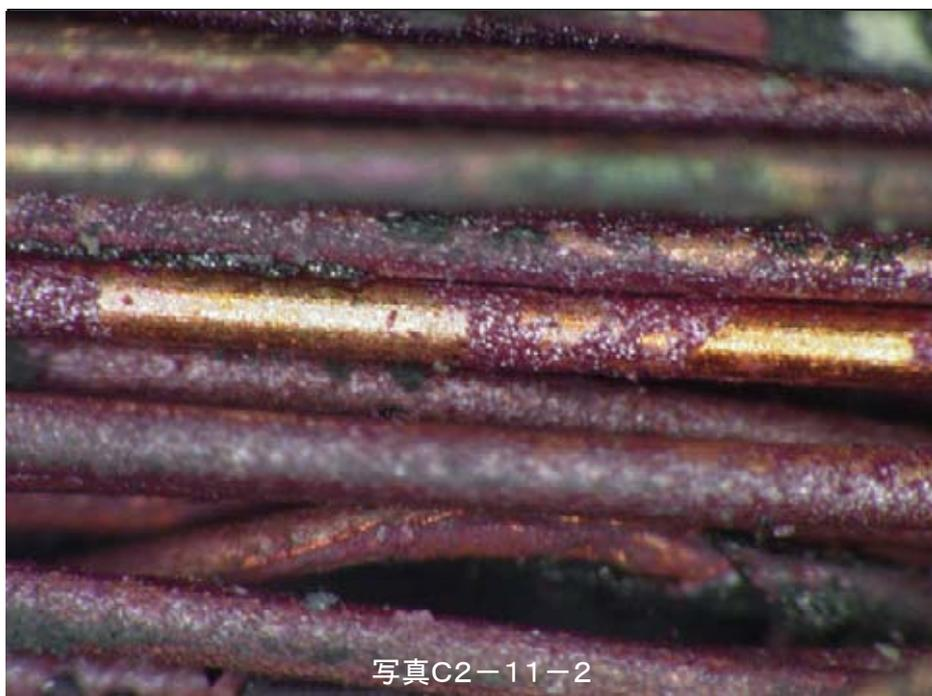
写真C2-11-1は、電気炉加熱でルビー色の生成物が見られたEM-ECTFサンプルの外観で、写真C2-11-2はその拡大。
