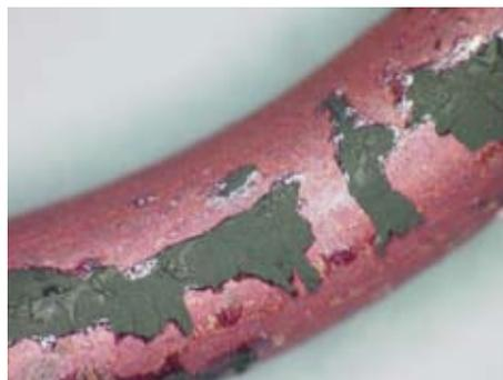
写真 28 被覆を除去して電気炉加熱した試料No. 1 (800°C 10分)
