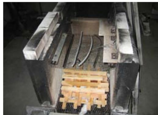
写真5 コンクリートブロック炉内部の様子
