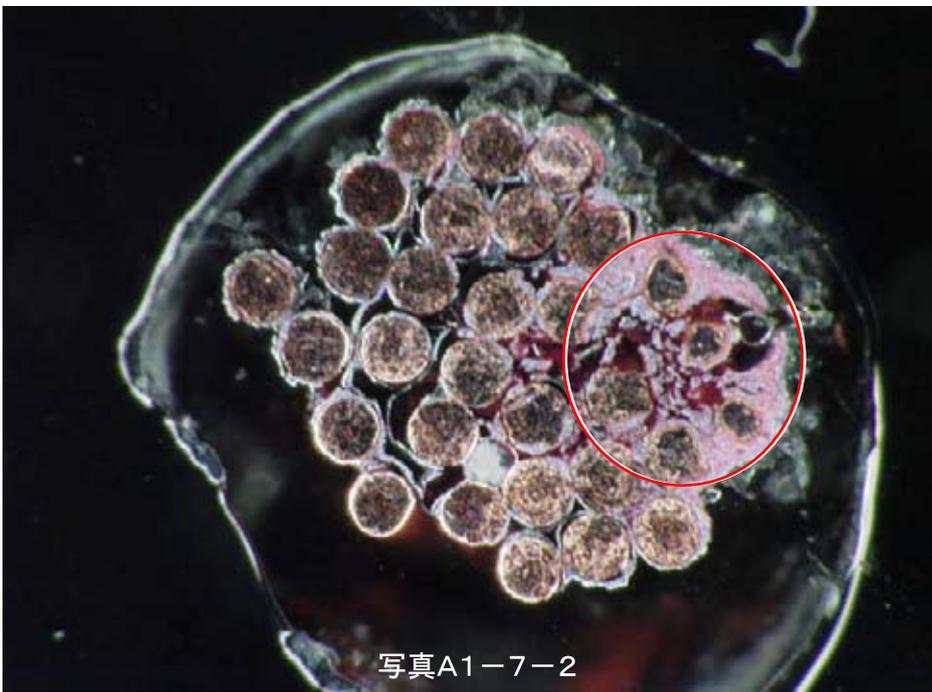
写真A1-7-1は、二次被熱で線径減少が見られたVFFサンプルの外観で、二次被熱サンプルでは特殊条件下(本文1頁参照)でないとはほとんど観察されないと思われるもの。外観では著しく線径が減少しているようには見えないが、写真A1-7-2のとおり断面を観察すると外周部の一部に著しく線径が減少した素線が見られた(写真の赤円内)。断面の画像解析から求めた線径は最小で0.1mmであった。
