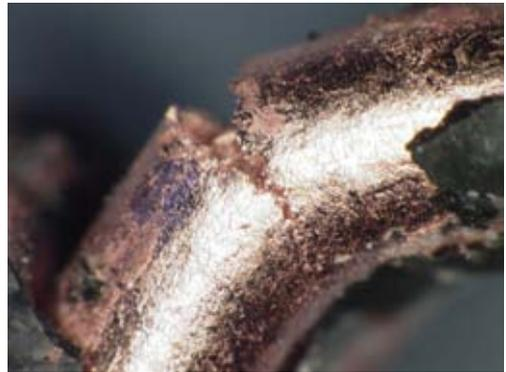
写真17 電気炉800℃60分加熱サンプル(試料No. 1)
