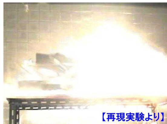
点火から12分55秒で左側のカセットこんろのカセットボンベが破裂、爆発
