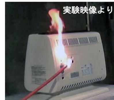
適正な接続具のガスコードではなく、ゴム管を使ったためにガスが漏れて引火しました。
