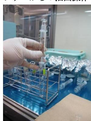
写真10 HPLC 試料ろ過・微粒子除去用フィルターによるろ過操作
