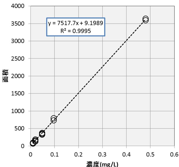
図 8 低濃度用標準液系列による検量線
