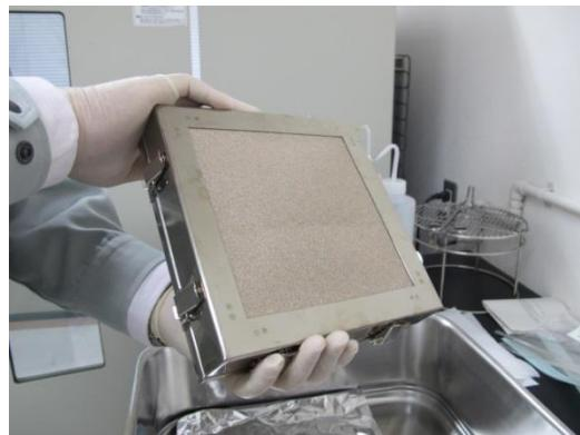
写真4 試験対象品を取り付けたシールボックス
