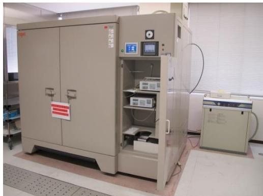
写真 17 小形チャンバーシステム ( $1\text{m}^3$ ) の外観
