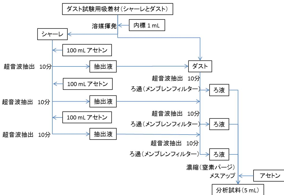
図 5 ダスト試験用吸着材の抽出手順
