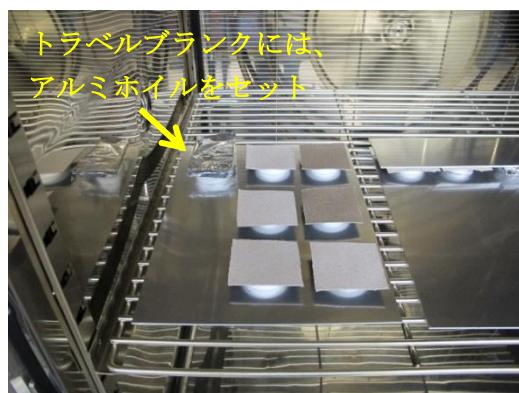
写真 20 シャーレ上部への試験対象品の設置
