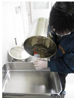
写真 12 20L チャンバーの洗浄操作 2
