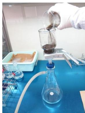
写真 34 メンブレンフィルターによるろ過操作
