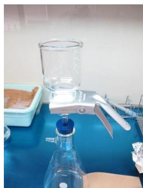
写真 15 メンブレンフィルターをセットしたろ過装置
