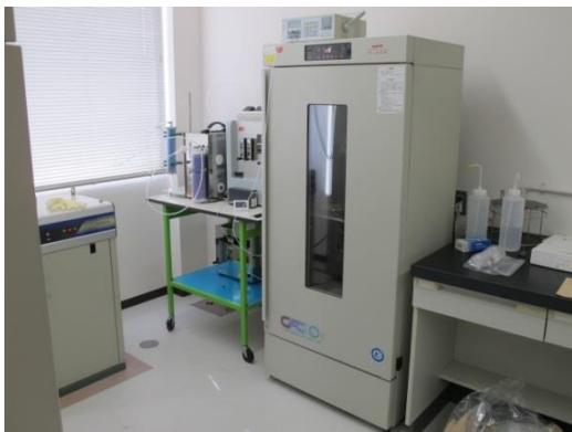
写真3 小形チャンバーシステム (20L) の外観
