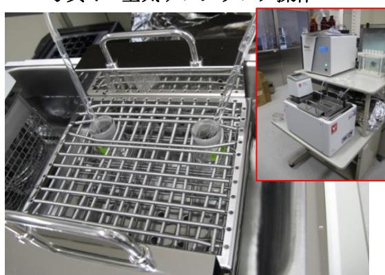
写真9 窒素パージによる濃縮操作
