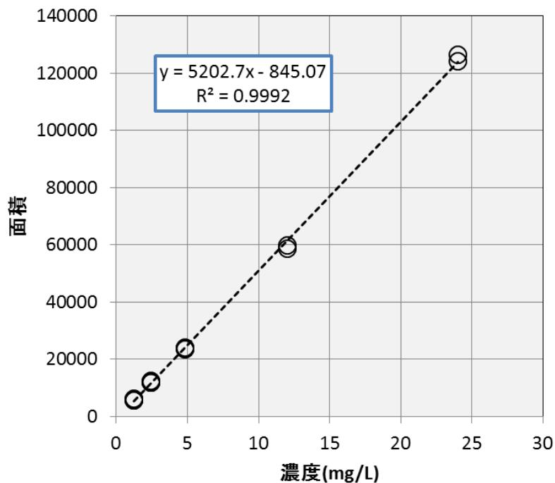
図 7 高濃度用標準液系列による検量線
