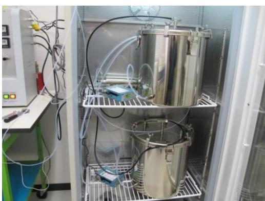
写真5 小形チャンバーシステム (20L) の恒温槽内部
