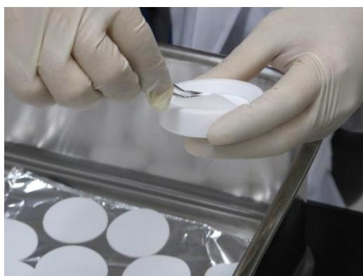
写真 19 シャーレへの固相抽出ディスクの装着
