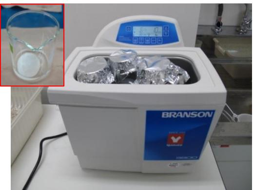
写真 22 固相抽出ディスクの超音波抽出操作
